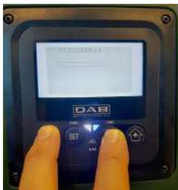
Рисунок 9С – Доступ к Loader для обновления e.sybox
