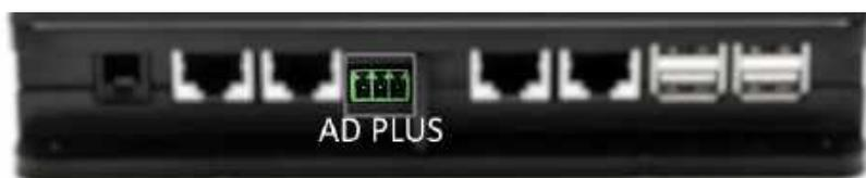
Рисунок 9А – Положение разъема в AD plus и в DConnect Box, пример подключения прямого кабеля can-bus к разъему DConnect Box для подсоединения AD plus
