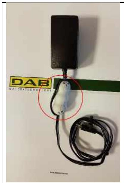
Рисунок 11 - Положение ферритового сердечника
